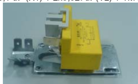
Condensateur Anti-parasite 0,1 uF (X1) + 2x0,027uF(Y2) + 1M Ω
